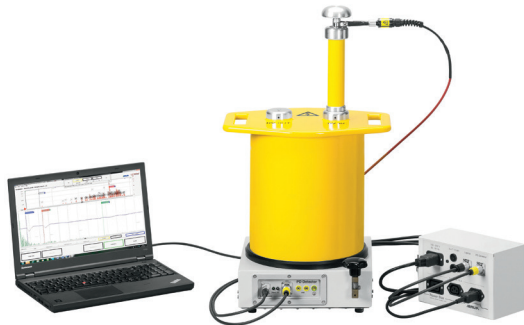
Abbildung: PD-TaD 62 mit Laptop und Power Box
